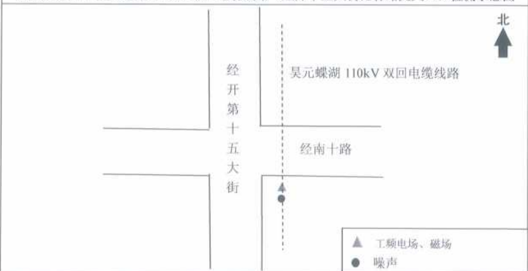
检测示意图 5 吴元蝶湖 110kV 双回电缆线路（经开十五大街经南十路交叉口）检测示意图
