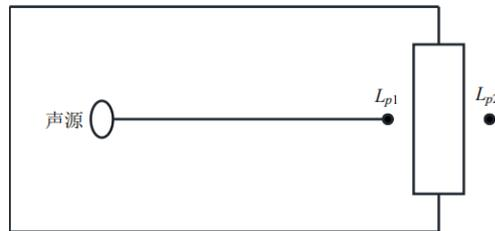
图 7 室内声源等效为室外声源图例
